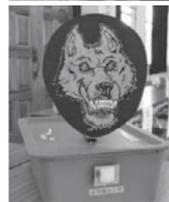
【写真④】一般社団法人福島県発明協会会長賞を受賞した島田海斗さん(埴工高3年)【写真⑤】島田海斗さんと寺内颯汰さん(同3年)が発明した「赤外線感知による『狼の音声と目の点灯による鳥獣防止』」。甚大なイノシシ被害を考え、鳥獣の赤外線をキャッチすることで、狼の音声が発生するとともに、目が点灯し、お面が左右に動く発明品
